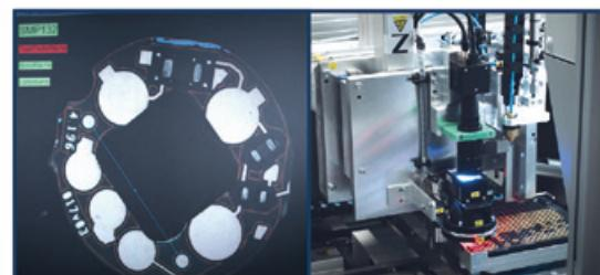
Vision Q.400 erkennt automatisch die Produktionsqualität von Aortenklappen, überprüft ob Montageteile korrekt angebracht wurden oder zählt Bakterienkulturen auf Nährfilmen unter verschiedenen Umgebungsbedingungen. Dank der unterschiedlichsten Kamera Filter ist Vision Q.400 in der Lage, trotz schwankender Lichtverhältnisse, ein klares Bild und ein sicheres Ergebnis zu liefern.
